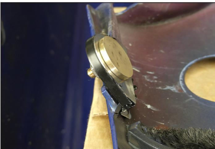
Verstärkung Befestigung Kotflügel
